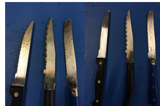
Lames de couteau nettoyées avec un équipement CLEANITool : traitement ultrasons inférieur à 1 minute.
